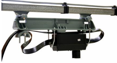
Askılı kabloda hareket ettirilebilir kontrol ünitesinin kumanda arabası
